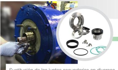
Sustitución de las juntas secundarias en diversos materiales: NBR, EPDM, EPDMPEROX, FPM, FFKM, AFLAS, HNBR, PTFE, etc.
