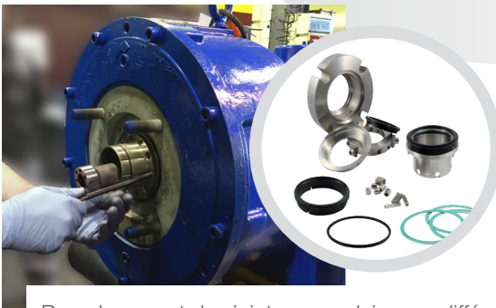
Remplacement des joints secondaires en différents matériaux : NBR, EPDM, EPDMPEROX, FPM, FFKM, AFLAS, HNBR, PTFE, etc.
