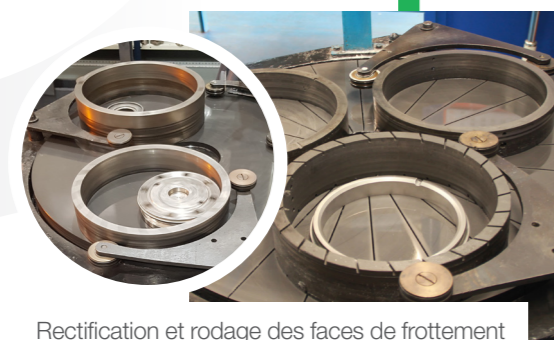
Rectification et rodage des faces de frottement en carbure de silicium ou carbure de tungstène, et fabrication de ces mêmes faces à base de matériaux comme le graphite, l'antimoine ou le PTFE.
